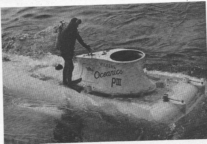
Afb. 1 Miniatuur-onderzeeboot voor het in de zeebodem verzinken van de versterkerkasten in ondiep water waar het gevaar voor beschadiging door scheepsankers, sleepnetten en getijstroom bestaat.
